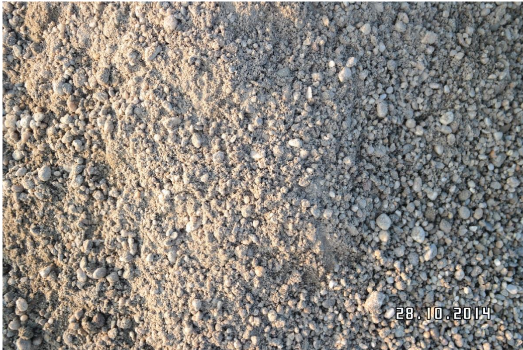
Slika 5.29. Građevni pijesak i šljunak iz eksploatacijskog polja Zlatno jezero u rovnom stanju (Foto B. Kruk)
